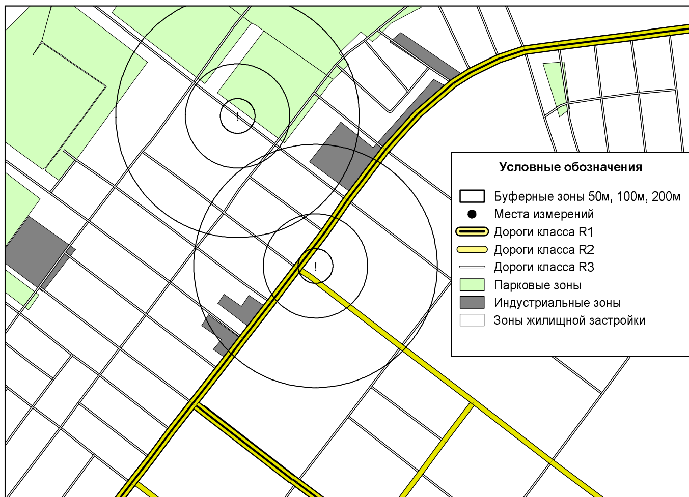
Рис.2. Определение переменных ГИС в местах отбора проб
